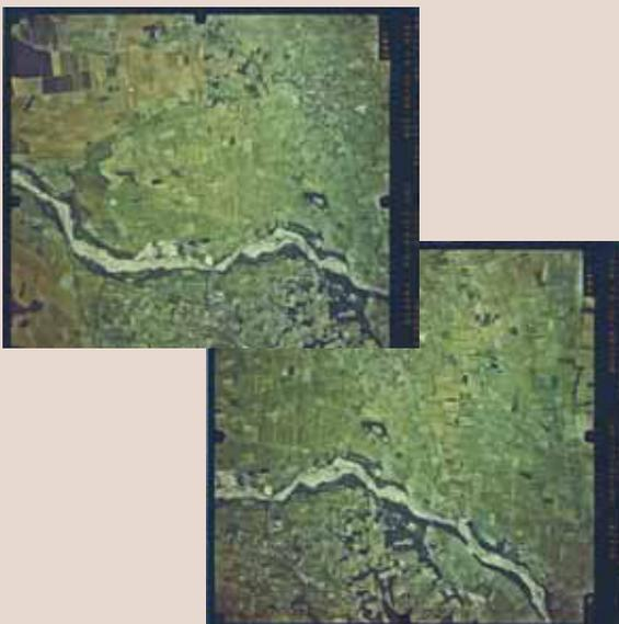
L'opérateur utilise un *stéréoscope*\* (appareil binoculaire) sur un couple de photographies pour acquérir la vision du relief : un même détail est perçu par chaque œil sous un angle différent et la fusion des images par le cerveau donne l'impression de relief. Le géomorphologue analyse et interprète le fonctionnement du cours d'eau à partir de la morphologie qu'il perçoit et reporte sur un fond de plan les unités hydrogéomorphologiques.
