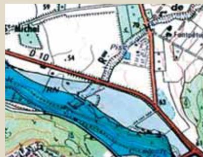
Cartographie des zones inondables de l'Arc (13) réalisée sans prise en compte d'un ruisseau affluent
