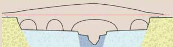
La mise en charge d'un ouvrage entraîne une surélévation artificielle de la ligne d'eau (en rouge) et éventuellement des débordements sur les terrasses (cf. page 18).
