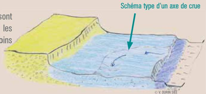
Exemple de fonctionnement de plusieurs axes de crue
